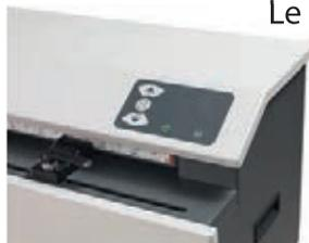
Le panneau de commande intuitif doté d'affichages LED et d'un clavier robuste indique l'état de fonctionnement de l'appareil.
