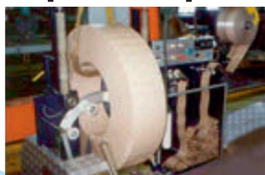
Les papiers crêpés VCI sont fabriqués pour offrir une résistance extrême, une résistance à l'abrasion, un **amortissement entre les couches et une protection contre la corrosion** des composants autour desquels ils sont utilisés. Le crêpage aide à **allonger le papier crêpé lors de l'emballage automatique et protège le déchirement du papier des arêtes vives**. L'allongement peut être contrôlé et réglé à 25-100% de la longueur réelle.
